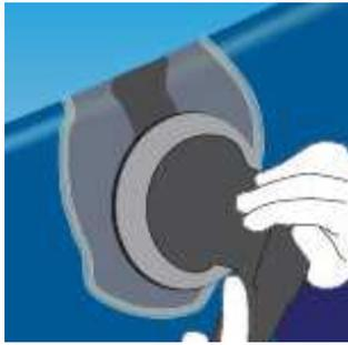
3. Después de esperar 20 minutos se procede al lijado final del reparador utilizando disco abrasivo de grano P180, afinando sucesivamente hasta el grano de afinado recomendado por el fabricante de pintura para aplicar la imprimación correspondiente.
