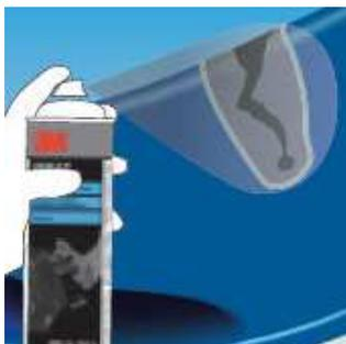
1. Aplicar un velo del promotor de adhesión 05917 de 3M si la pieza es de plástico poliolefínico o termoplástico (PE, PP, EPDM, TEO, METTON, ect). **Atención: No aplicar 05917 de 3M sobre el plástico de tipo ABS.** Esperar durante 10 minutos al completo secado del producto.
