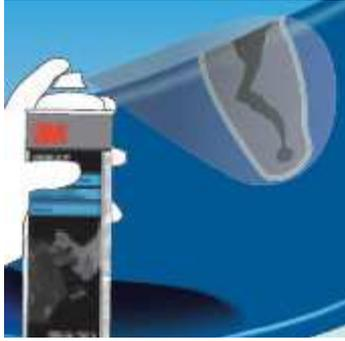
3. Aplicar un velo de promotor de adhesión 05917 de 3M, si la pieza es de plástico de tipo poliolefínico o termoplástico (PE, PP, EPDM, TEO, METTON, ect). **ATENCIÓN: no aplicar 05917 de 3M sobre plástico tipo ABS.** Esperar 10 minutos al completo secado del producto.
