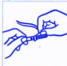
1. Enganche el arnés pasando la banda perforada por la hebilla y ajústelo presionando a la longitud deseada. Realice la misma operación con la otra banda.
