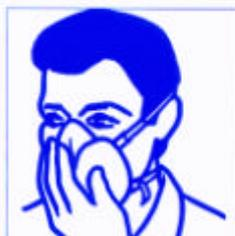
5. Antes de entrar en el área contaminada se debe comprobar el correcto ajuste del respirador. Para ello realice la prueba de la presión positiva: tape con la palma de la mano la válvula de exhalación y exhale con fuerza. Si el respirador se hincha ligeramente y no se observan fugas de aire entre los bordes del respirador y la cara,
