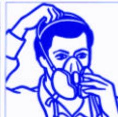
2. Coloque el respirador sobre la cara, de forma que quede cómodamente sobre el puente de la nariz, y el arnés sobre la parte superior de la cabeza.
